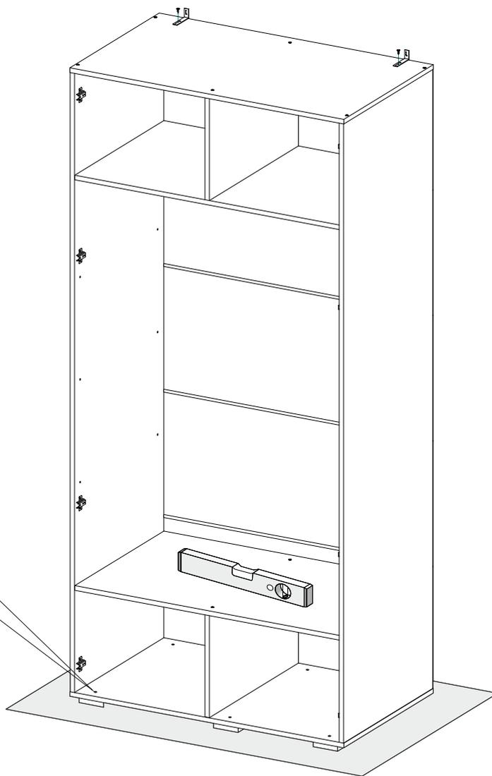
**!** Регулировка опор производится плоской отверткой через сквозные отверстия в крышке поз. 4.
