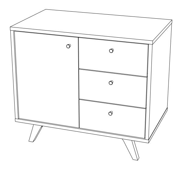
Максимальная нагрузка на роликовые направляющие до 8 кг. (нагрузка должна быть распределена по всей площади ящика).
