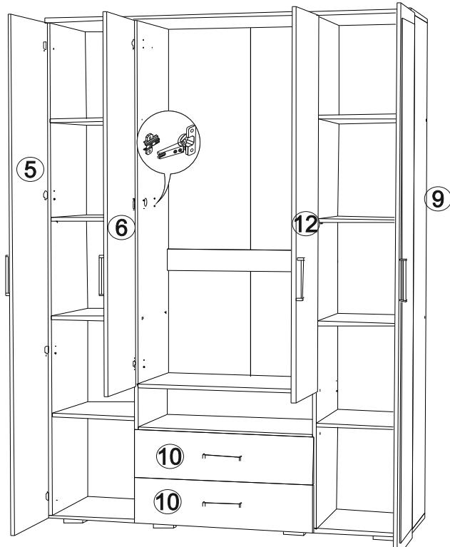
Регулирование зазоров и положения дверей с петлями
